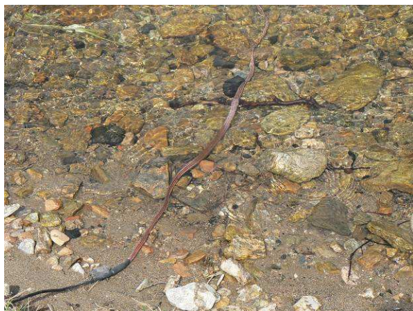
Cliché 63. Cathode sous forme de tresse d'un appareil de pêche électrique – FDPPMA43 © Arnaud Tanguy
