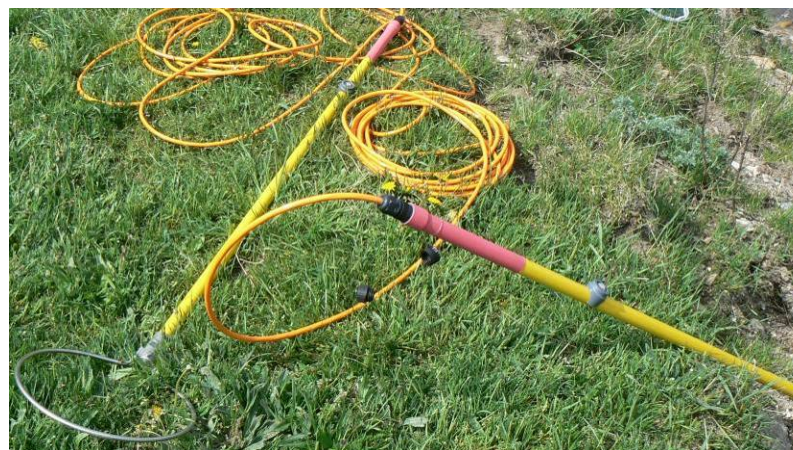
Cliché 63. Cathode sous forme de tresse d'un appareil de pêche électrique – FDPPMA43 © Arnaud Tanguy
